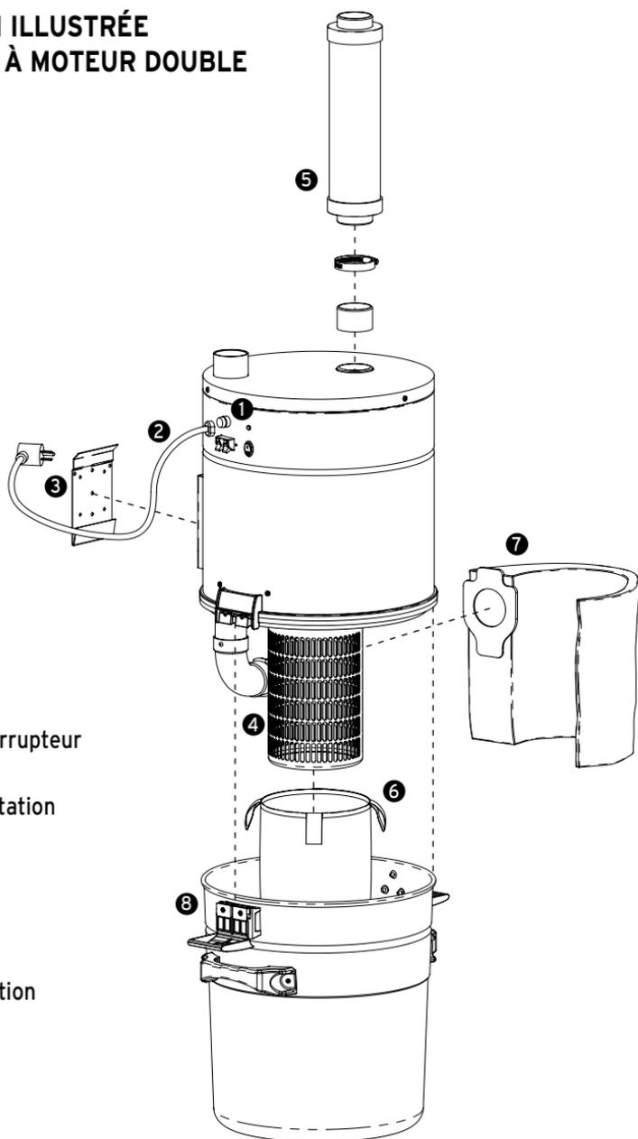
1. Disjoncteur, interrupteur et prise 24V
