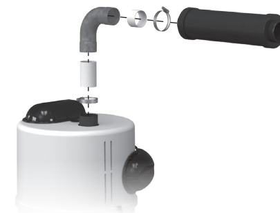
Installation avec un coude à 90°.
